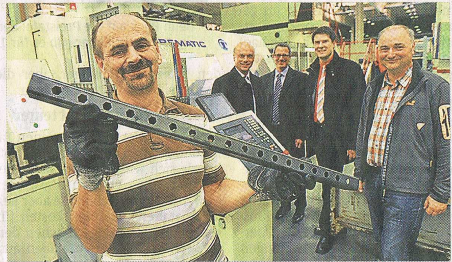
Bernd Baier bedient den Automaten, mit dessen Hilfe in Rohrmaterial verschiedene geometrisch geformte Löcher gelasert werden. Das und vieles mehr zeigten Gerhard Rank (l.), Jürgen Hannig und Henry Görlitz (r.) dem CDU-Landtagsabgeordneten Sven Liebhauser.
